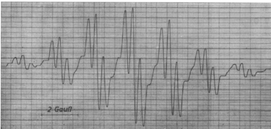
Abb. 6. ESR-Spektrum des 2-[p-Chlor-phenyl]-bis-[4,4'-dibrom-biphenyl]-allyls in Benzol ( c = 5 \cdot 10^{-6} Mol/l)
